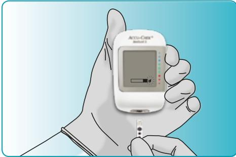
3. Para encender el medidor inserte la tira reactiva en el medidor. Cuando el símbolo de gota de sangre se prenda, puede realizar una prueba.
